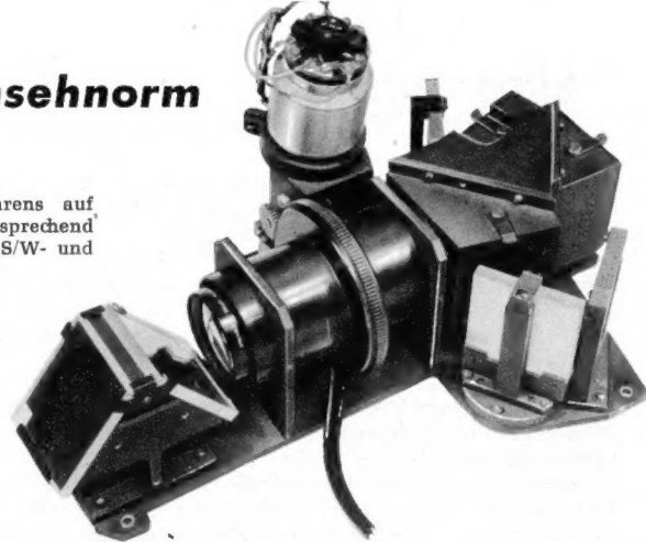
Bild 1. Optische Einrichtung der Marconi-Dreifarben-Bildaufnahmekamera im BBC-Farbfernsehstudio London. Dreifarbenfilter und halbdurchlässige Spiegelzerlegen das Licht der aufgenommenen Studioszene in die drei Grundfarben und führen diese Komponenten den drei Aufnahmeröhren zu
