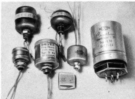
Bild 1. Größenvergleich von hochwertigen Eingangübertragern verschiedener Hersteller mit einem Sahnebonbon. Die Hersteller der Übertrager sind die Firmen Eugen Beyer, Heilbronn/Neckar; Helmut Haufe, Usingen/Taunus; Labor W, Bissendorf/Hannover
